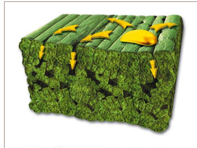
À partir de la gouttelette de bouillie déposée à la surface, le Krésoxim-méthyl entre profondément dans les tissus.
