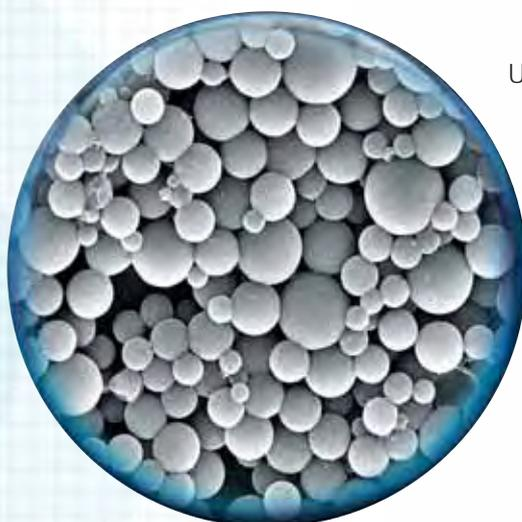
Une observation de la formulation de ATIC® AQUA au microscope révèle de nombreuses microcapsules. Elles sont en suspension dans une solution aqueuse, sans solvant organique. Par un procédé chimique original, les particules de matières actives ont été enfermées dans un filet de polymère pour constituer les capsules.
