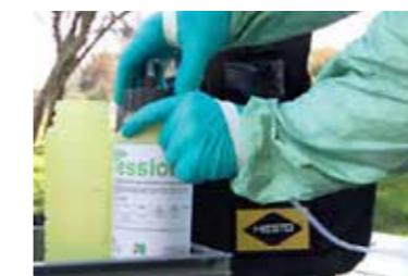
2 Passer à nouveau la pulvérisation en « MODE C ». **Viser un bidon Tessor® vide dit « bidon PPNU » et presser la gâchette du pistolet en continu afin de purger le système.**
