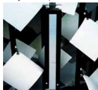
Après réglages du pulvérisateur : Homogénéité de la pulvérisation
