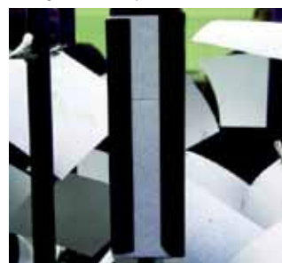
Après réglages du pulvérisateur : Homogénéité de la pulvérisation
