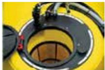
Pour certains pulvérisateurs où le produit passe du bac incorporateur par le « trou d'homme » avant d'arriver dans la cuve : si l'accessibilité le permet et s'il n'y a pas de risque d'éclaboussure avec l'agitation, privilégier la mise en œuvre du produit en formulation WG via le « trou d'homme ».
