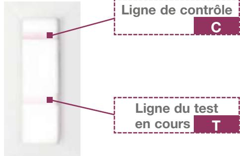
La ligne supérieure correspond à la **ligne de contrôle (C)** et doit apparaître sur chacune des bandelettes validant ainsi le résultat du test. Si cette ligne n'apparaît pas, cela indique une détérioration de la bandelette, répéter le test.
