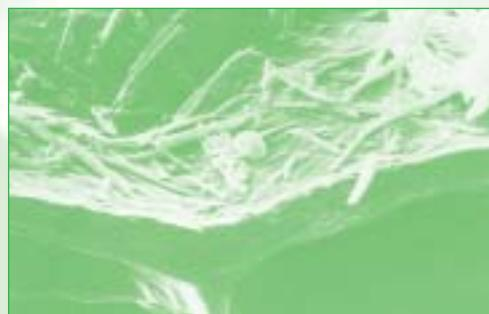
Les cristaux d'hydroxyde ont la forme de très petites aiguilles (moins de 2,4 µm) liées les unes aux autres et formant un réseau stable à la surface de la feuille.
