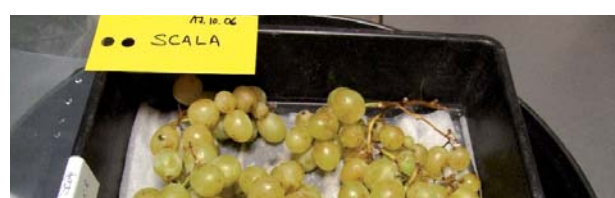
Test fongicide en terrine sur baies de raisins italia : à J+8, efficacité de Scala contre Aspergillus carbonarius démontrée. Mode opératoire : J : traitement Scala (base dose ha). J+1 : micro-blessures et contaminations avec des souches d' Aspergillus carbonarius . J+8 : observations.
